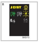
Tastenfeld "OPEN" blinkt. Durch Drücken von Tastenfeld "OPEN" wird der Prozess zum Öffnen der Sattelkupplung gestartet.
