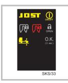
Die Sattelzugmaschine ist abgesattelt, jedoch wird ein nicht vorhandener Zugsattelzapfen oder Auflieger erkannt:
