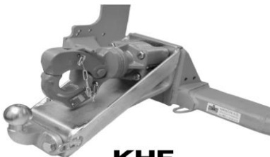
...KHF Traverse kombiniert mit Hakenkupplung und fester Kugel Traverse combiné avec crochet de remorque fixe et boule fixe
